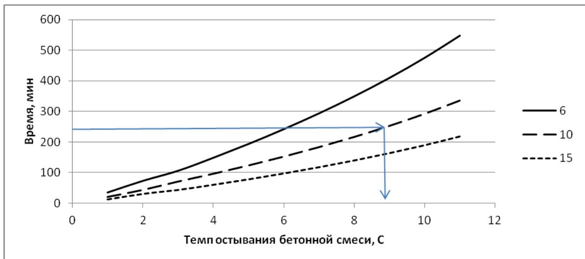
6, 10, 15 – массивность конструкции
