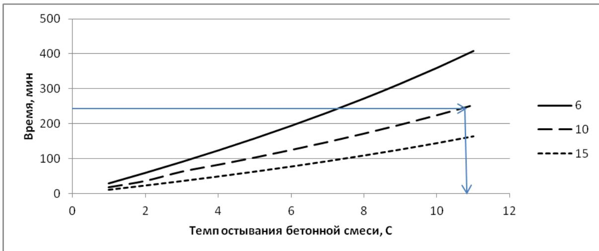
6, 10, 15 – массивность конструкции
