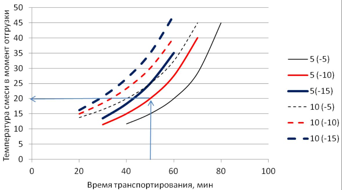
5 (-10) – соответственно 5 - температура бетонной смеси, °С, в момент укладки; (-10) - температура наружного воздуха, °С
