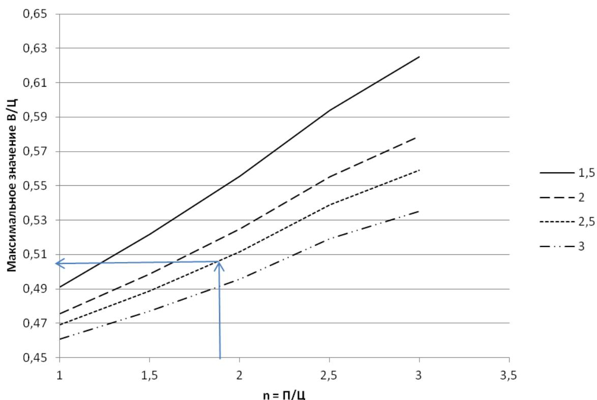
1,5; 2; 2,5; 3 – модуль крупности песка;  $\Pi$  – расход песка,  $\text{кг}/\text{м}^3$ ;
