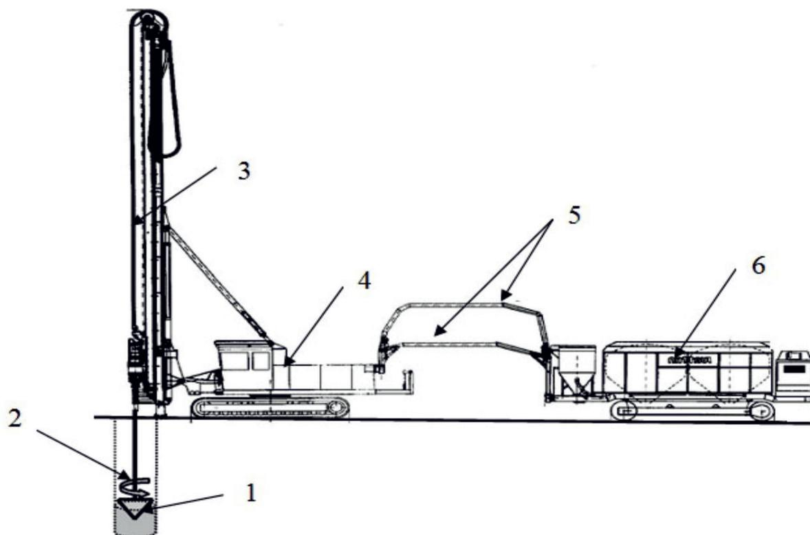
1 – конус; 2 – шнековый смеситель; 3 – штанга; 4 – базовая буровая машина;
