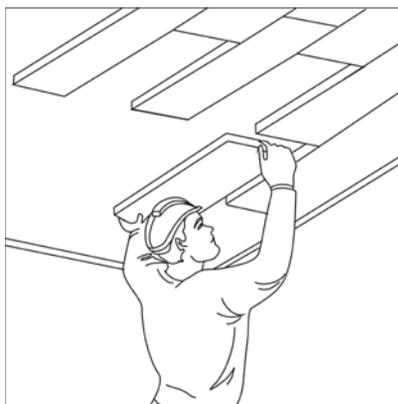
Рисунок 6.11 – Установка плит теплоизоляционных на перекрытие
