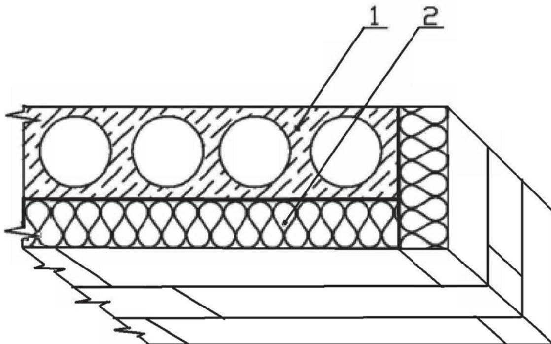
1 – плита перекрытия; 2 – плита теплоизоляционная и/или огнезащитная
