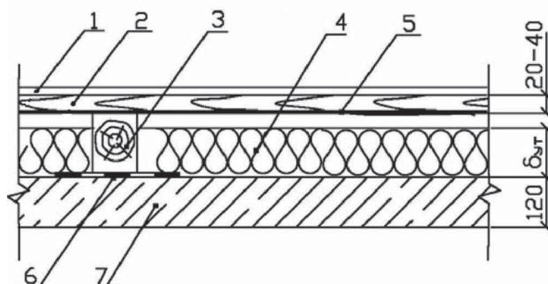
1 – покрытие пола; 2 – черновой пол; 3 – лага; 4 – плита теплоизоляционная;
