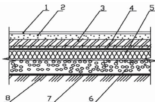
1 – покрытие пола; 2 – цементная стяжка; 3 – армированная бетонная стяжка;
