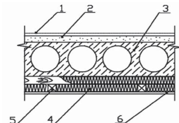
1 – покрытие пола; 2 – цементная стяжка; 3 – плита перекрытия;
