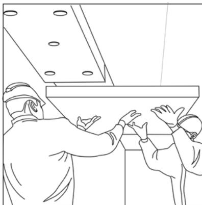
Рисунок 6.4 – Установка теплоизоляционной плиты к месту монтажа
