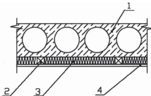
1 – плита перекрытия; 2 – обрешетка; 3 – плита минераловатная; 4 – плиты огнезащитные
