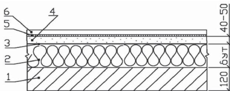
1 – плита перекрытия; 2 – плита теплоизоляционная; 3 – пароизоляционная пленка;
