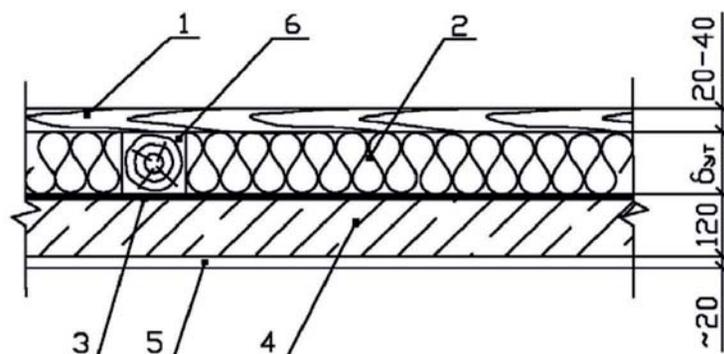
1 – деревянный настил; 2 – плита теплоизоляционная; 3 – пароизоляционная пленка;
