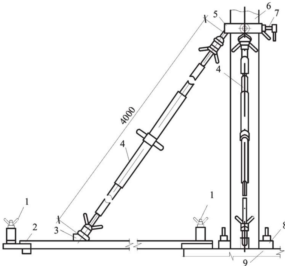
1 – анкер с натяжным крюком; 2 – балка; 3 – упор; 4 – телескопический подкос; 5 – хомут;
