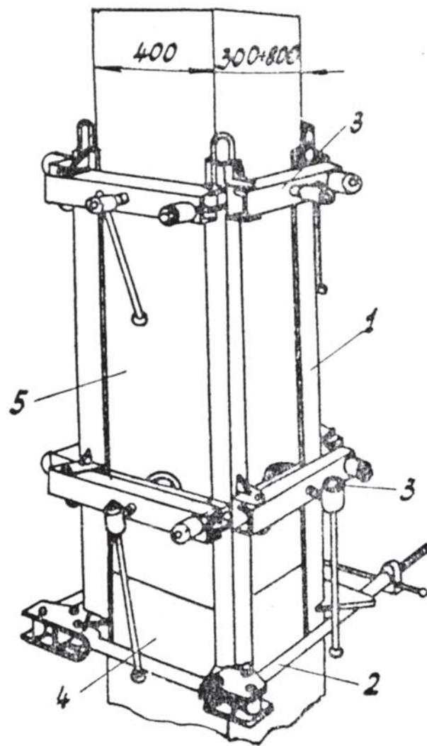
1 – стойка; 2 – зажимное устройство; 3 – регулировочное устройство; 4 – нижняя колонна;
