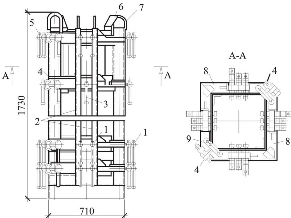
1 – винты для крепления кондуктора к оголовку колонны; 2 – стойки кондуктора;
