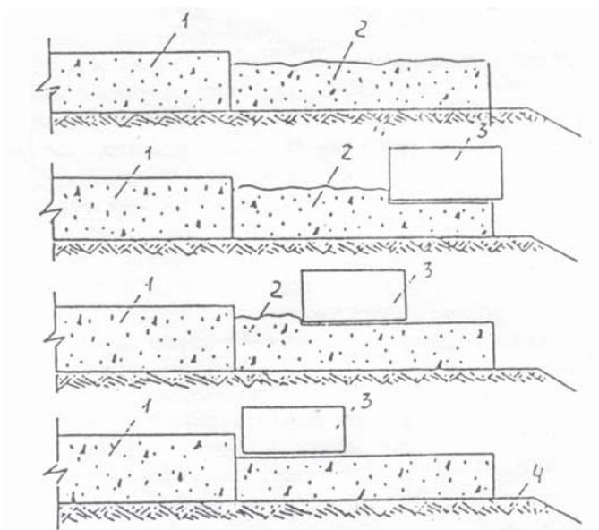
1 – ранее уложенный слой основания из уплотняемого бетона; 2 – распределенная на всю ширину бетонная смесь основания; 3 – валец катка; 4 – обочина
