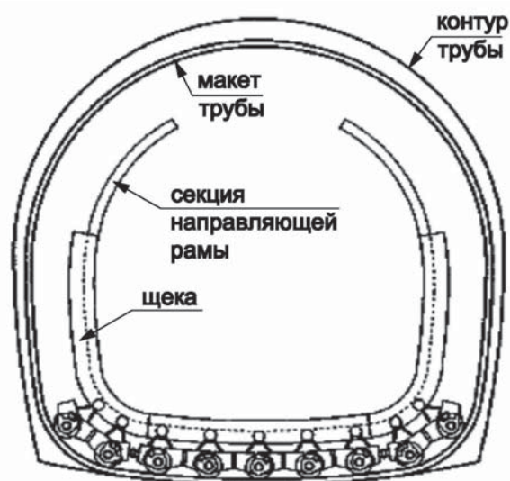
Рисунок 8 – Второй этап сборки навивочной машины
