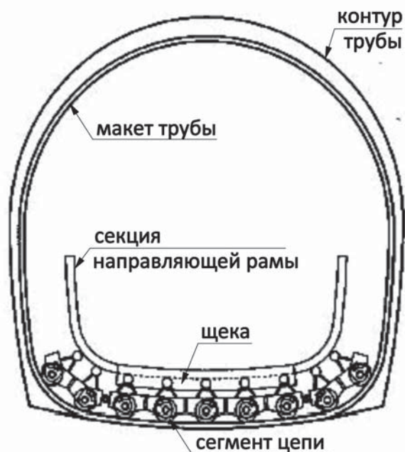
Рисунок 7 – Первый этап сборки навивочной машины
