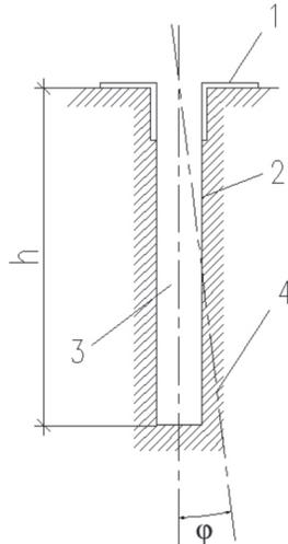
1 – форшахта; 2 – стена траншеи; 3 – проектное положение вертикальной оси траншеи;
