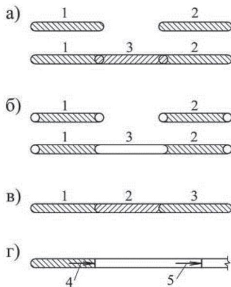
а) траншеи с пересекающимися секциями (захватками); б) соединяющиеся траншеи с образованием шва между захватками с помощью разделительных труб; в) траншеи с последовательным заполнением захваток бетонной смесью; г) траншеи с непрерывным заполнением захваток бетонной смесью
