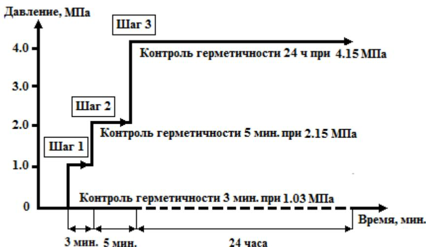
Рисунок 2 - Проверка герметичности азотом хладагента R 410A
