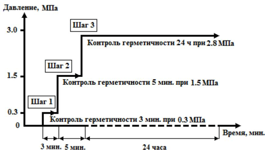
Рисунок 1 - Проверка герметичности азотом хладагентов R 22, R 407C
