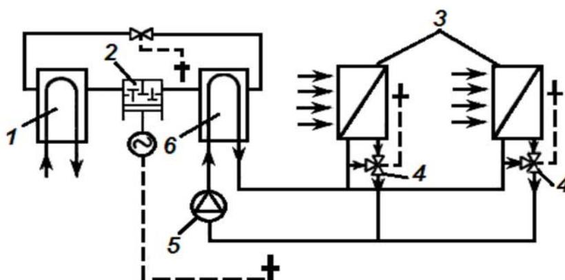
1 – конденсатор холодильной установки; 2 – компрессор холодильной установки; 3 – потребители холода (воздухоохладители); 4 – трехходовой смесительный клапан; 5 – насосная станция холодоносителя; 6 – испаритель холодильной установки
