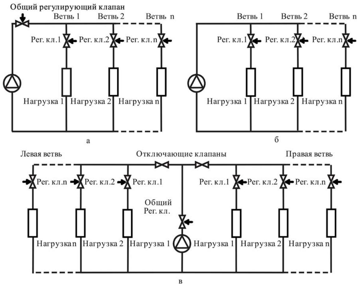
*a* – с общим регулирующим клапаном; *b* – без общего регулирующего клапана;
