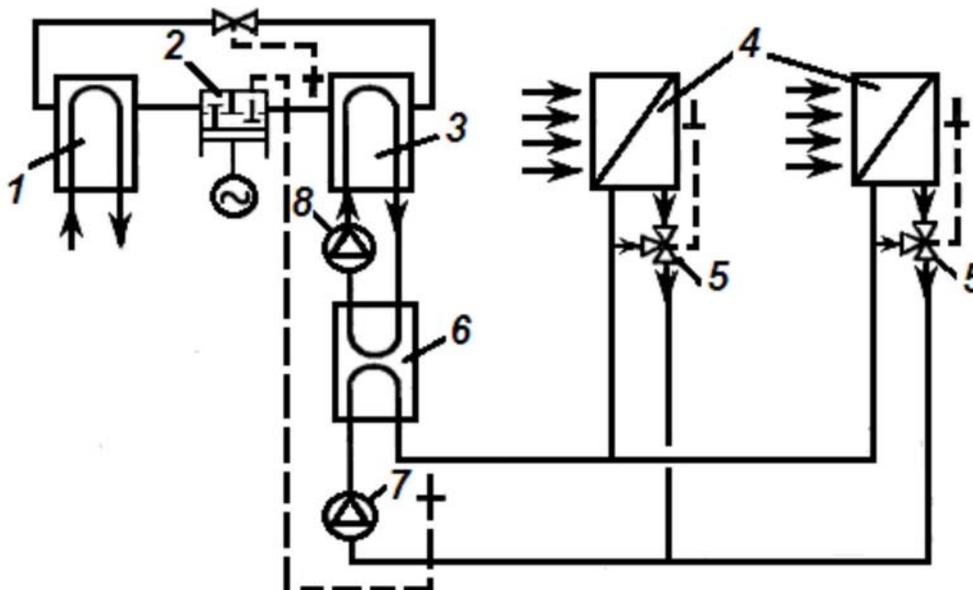
Первый контур: 1 – конденсатор холодильной установки; 2 – компрессор холодильной установки; 3 – испаритель холодильной установки; 6 – промежуточный теплообменник;
