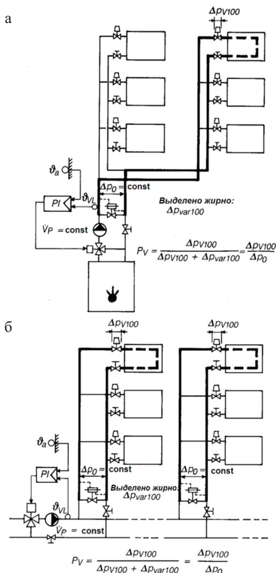
Рисунок 7.7 – Расчет авторитета клапана на примере 2-х систем
