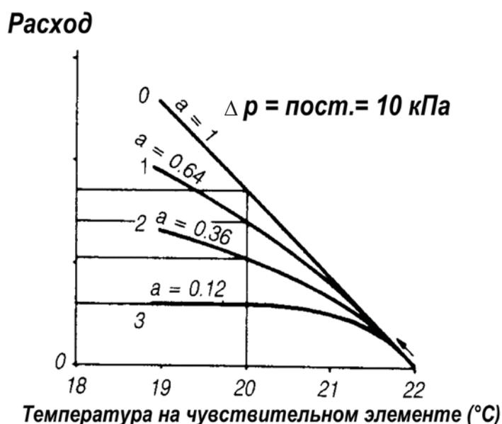
Рисунок 7.8 – Характеристики открытия термостатического вентиля с регулировкой через дополнительное гидравлическое сопротивление при различных настройках (кривые 0, 1, 2, 3)
