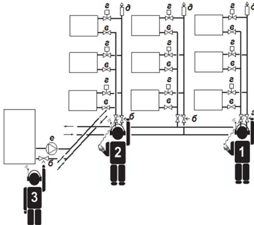
*a* – эталонный клапан балансировочный; *б* – клапаны-партнеры балансировочные;
