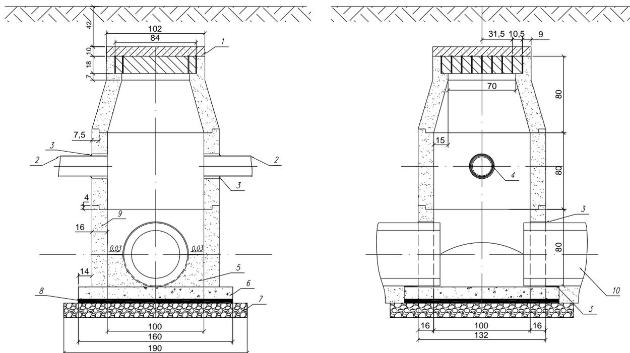
1- мятая глина, 2- перепуск, 3- обмазка битумом, 4- герметизирующий материал, 5- бетонный лоток, 6- днище колодца, 7- щебеночная подготовка, 8- выравнивающий слой, 9- стенка нижнего звена, 10 – труба коллектора.
