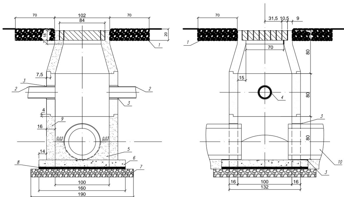
1- щебеночная отмостка с пропиткой битумом на 6-8 см, 2- перепуск, 3- обмазка битумом, 4- герметизирующий материал, 5- бетонный лоток, 6- днище колодца, 7- щебеночная подготовка, 8- выравнивающий слой, 9- стенка нижнего звена, 10 – труба коллектора
