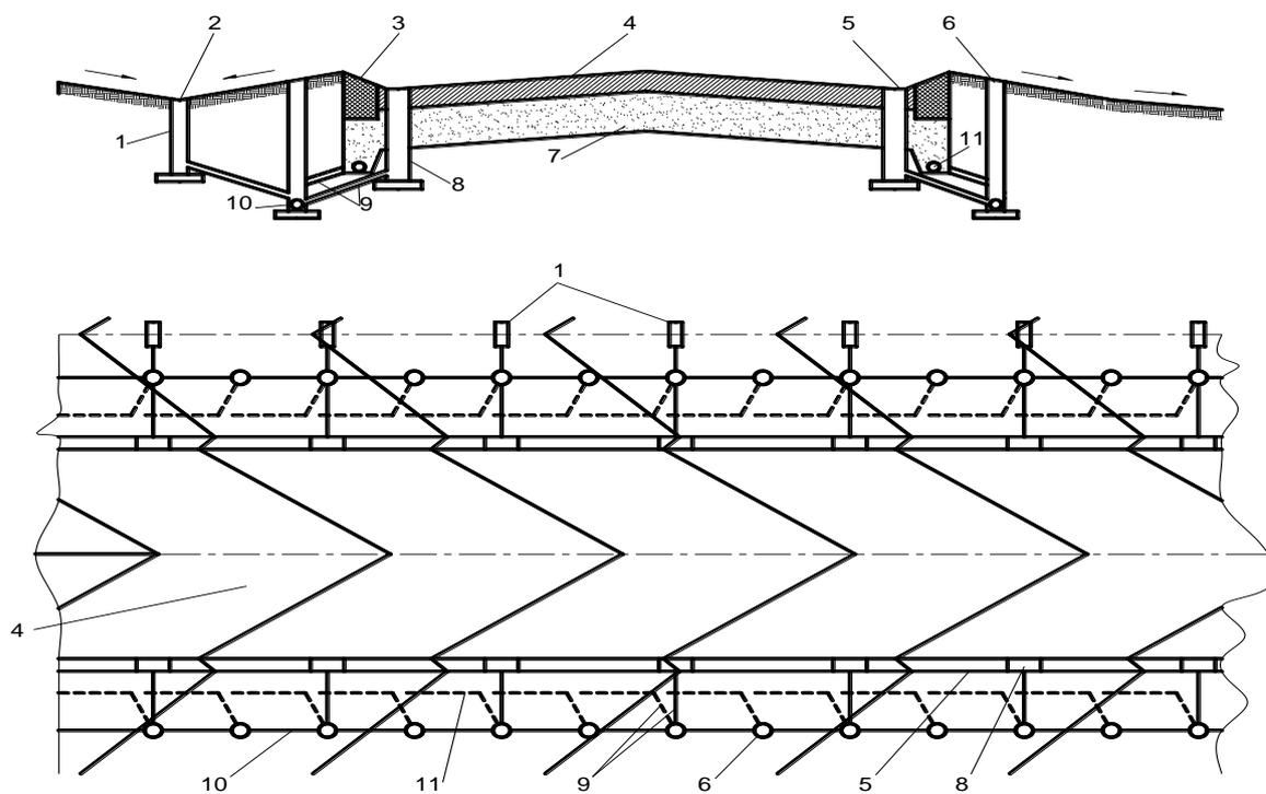
1- тальвежный колодец, 2- ось грунтового лотка, 3- отмостка, искусственное покрытие, 4- искусственное покрытие, 5- лоток в кромке покрытия, 6 – смотровой колодец, 7- основание с дренирующим слоем, 8 – дождеприемный колодец, 9 – перепуск, 10- труба коллектора, 11- дрена.
