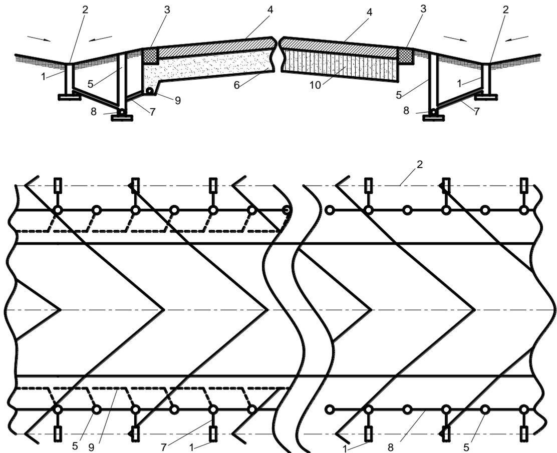
1- тальвежный колодец, 2- ось грунтового лотка, 3- отмотка, искусственное покрытие, 4- искусственное покрытие, 5- смотровой колодец, 6 –основание с дренирующим слоем, 7- перепуск, 8 – труба коллектора, 9 – дрена, 10 – основание без дренирующего слоя.
