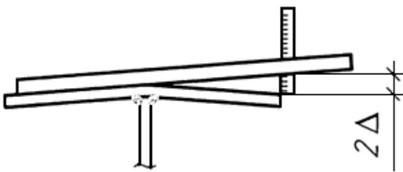
Рисунок И.17 – Измерение симметричной грибовидности линейками
