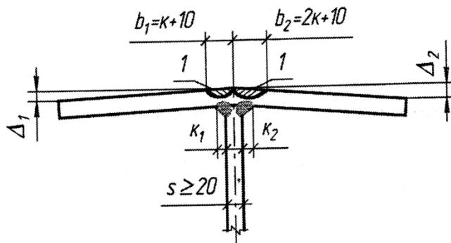
а – при толщине стенки  $S \leq 16$  мм; б – при толщине стенки  $S \geq 20$  мм; 1 – полосы нагрева
