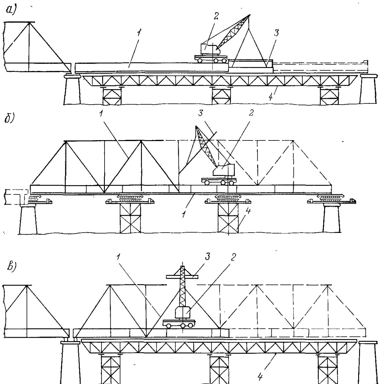
а – низовая сборка на сплошных подмостях; б – верховая сборка на нижних поясах ферм, надвинутых по промежуточным опорам; в – секционная сборка на сплошных подмостях; 1 – смонтированная часть конструкции пролетного строения; 2 – сборочный кран; 3 – устанавливаемый элемент; 4 – сборочные подмости
