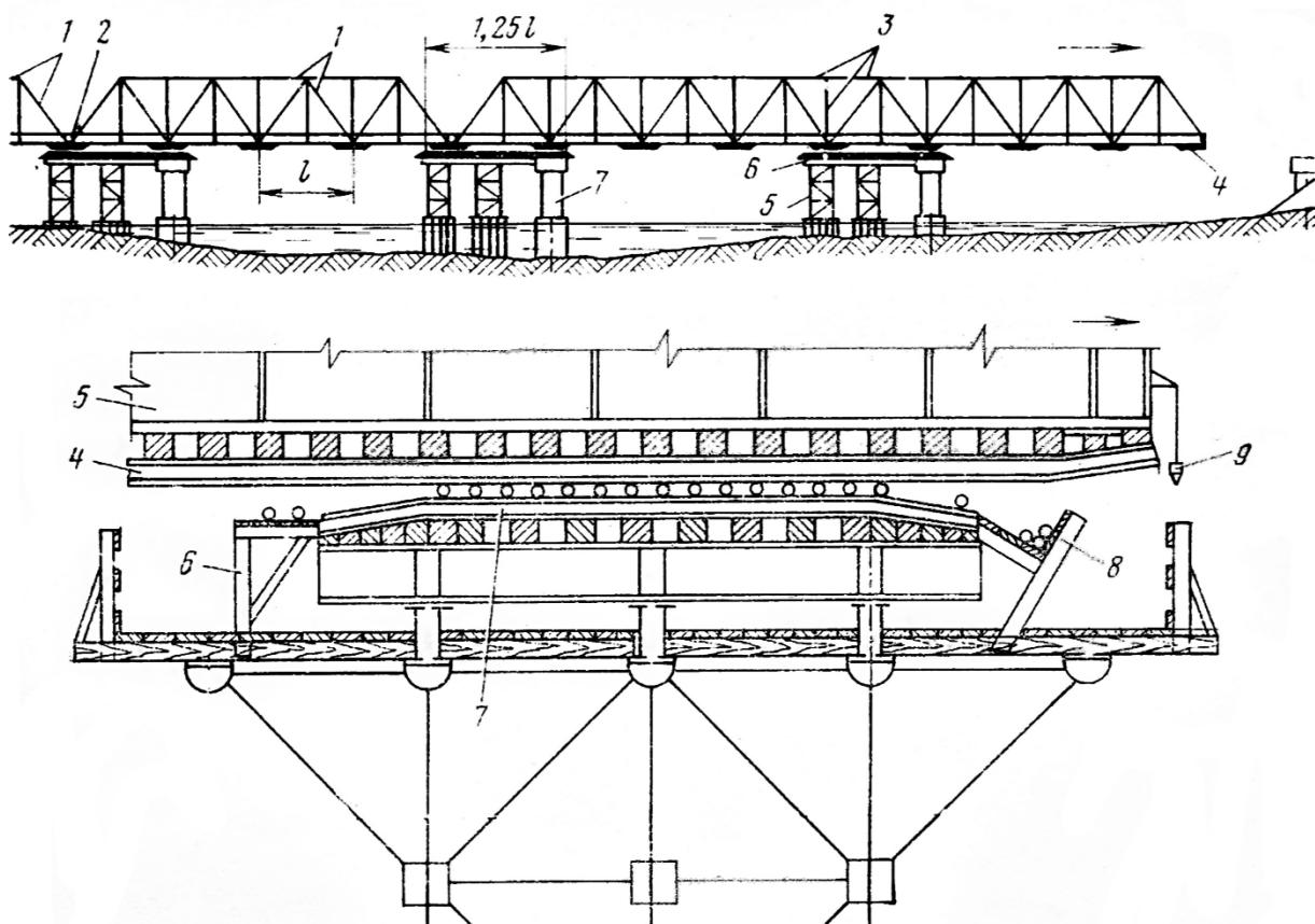
1 – разрезные балочные фермы; 2 – шарнирное соединение; 3 – соединительные элементы;
