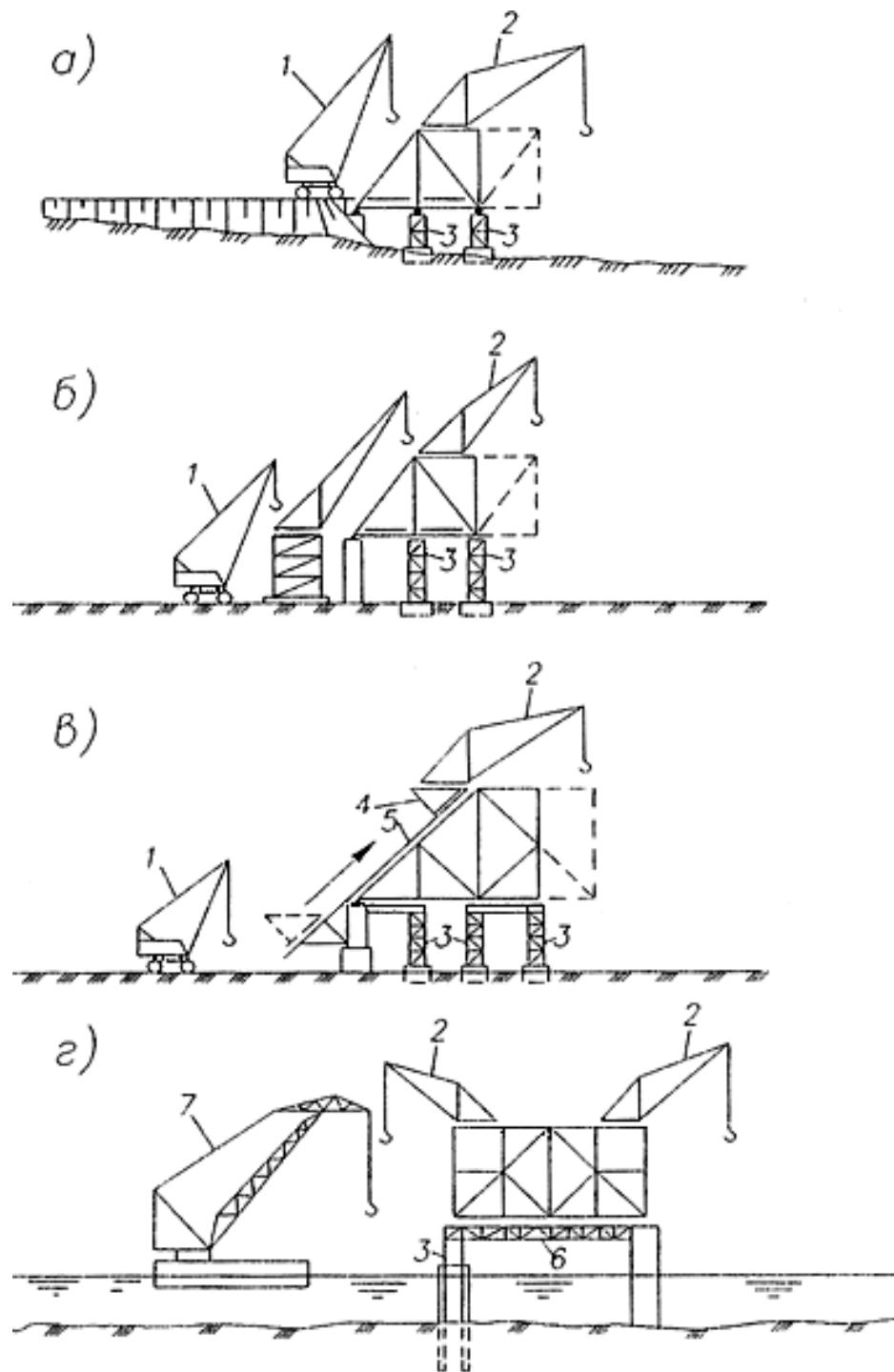
1 - стреловой самоходный полноповоротный кран; 2 - деррик-кран; 3 - временная опора; 4 - передвижная подставка; 5 - пути передвижения подставки; 6 - подмости; 7 - плавучий кран
