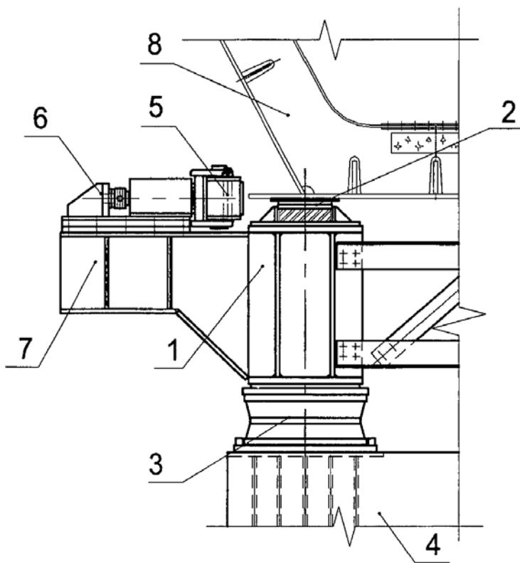
1 – балансирная балка накаточного устройства; 2 – устройство скольжения; 3 – опорная часть балансирной балки; 4 – подферменник опоры; 5 – направляющие ролики; 6 – винтовой домкрат; 7 – опорная конструкция направляющего устройства; 8 – надвигаемая конструкция
