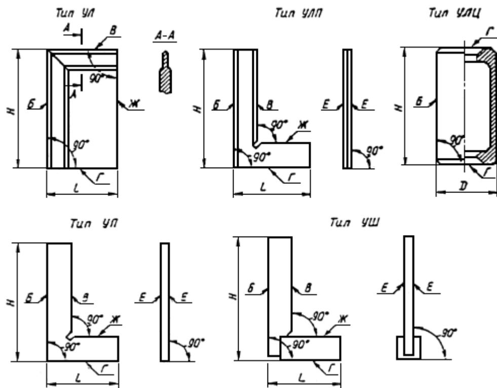
Б, В - измерительные поверхности угольников; Г, Ж - опорные поверхности; Е - боковые поверхности
