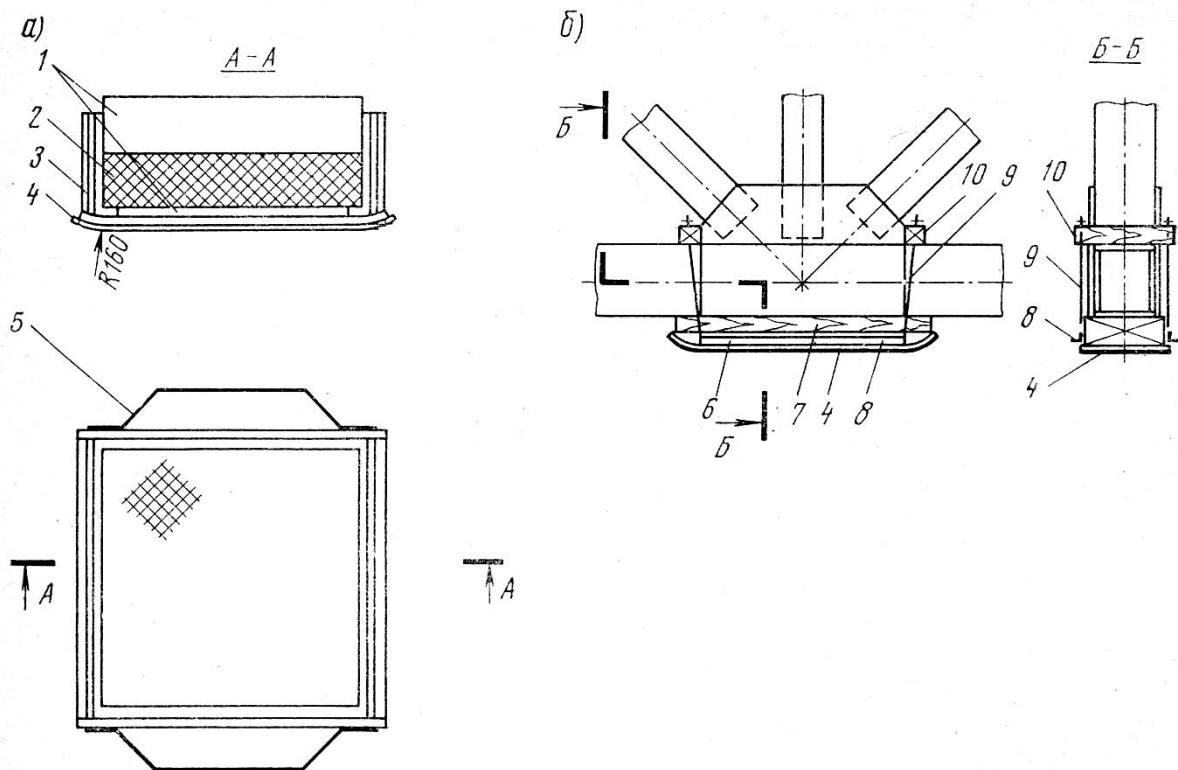
а – конструкция салазки; б – схема крепления салазки к узлу сквозного пролетного строения; 1 – фанера; 2 – резинометаллическая опорная часть (РОЧ); 3 – швеллер; 4 – стальной полированый лист; 5 – ручка; 6 – стальной лист; 7 – деревянная прокладка; 8 – бортовой уголок; 9 – тяж; 10 – упорный брус
