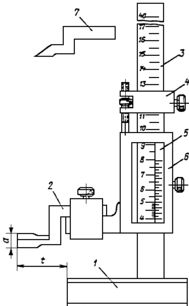
1 - основание; 2 - измерительная ножка; 3 - штанга; 4 - микрометрическая подача; 5 - нониус; 6 - рамка; 7 - разметочная ножка
