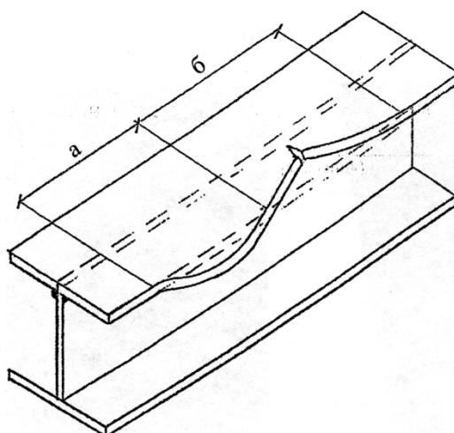
а – пластическая деформация по кромке; б – разрыв металла от механического удара
