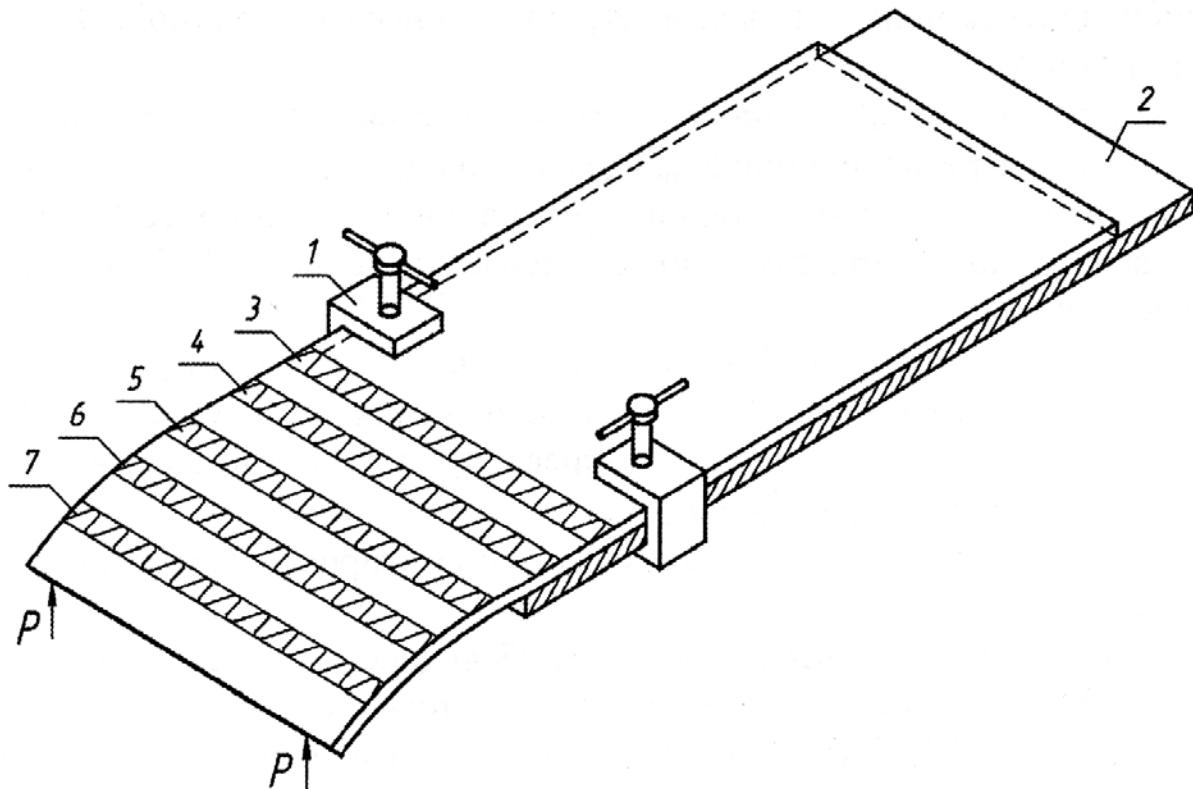
1 – струбцины; 2 – стол (стенд); 3-7 – полосы нагрева; Р – нагрузки (усилия домкратов)
