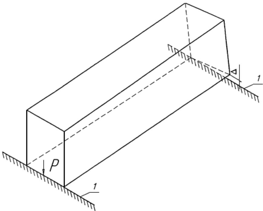
1 - горизонтальная опора; Р - усилие прижатия одного торца элемента к опоре
