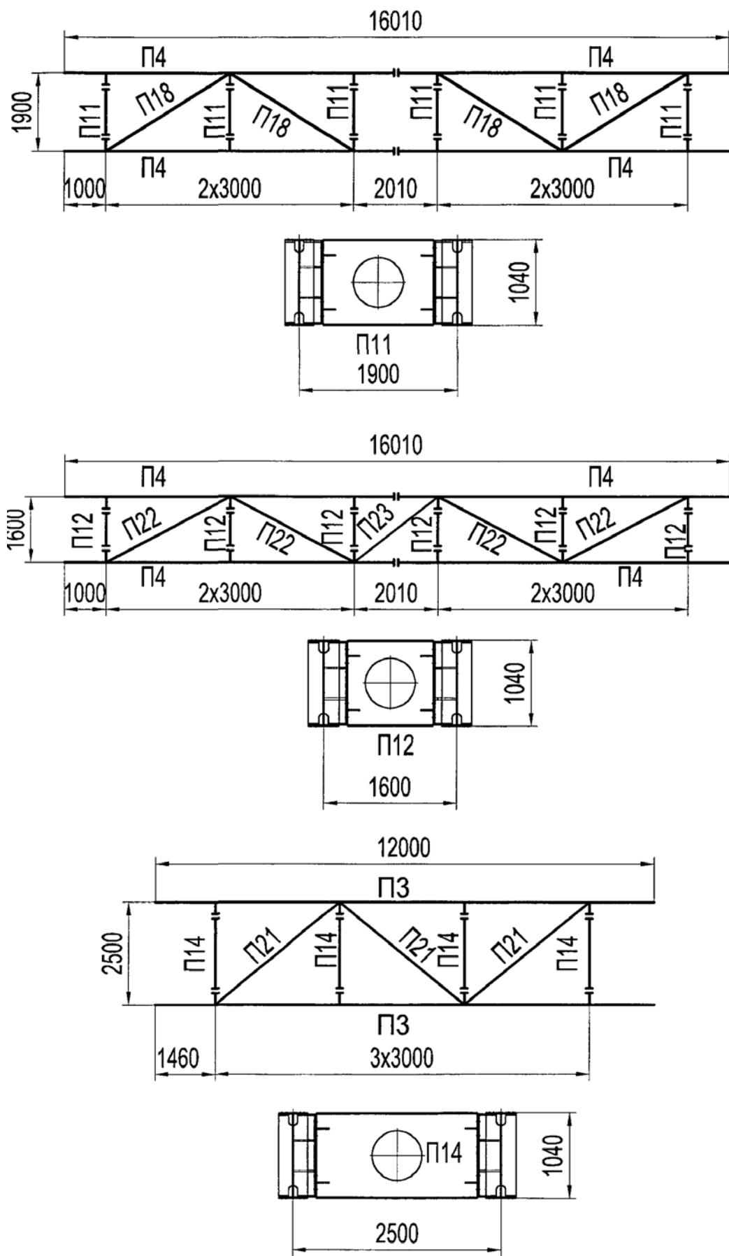
Рисунок 5.4 – Примеры монтажных схем инвентарных конструкций МИК-П
