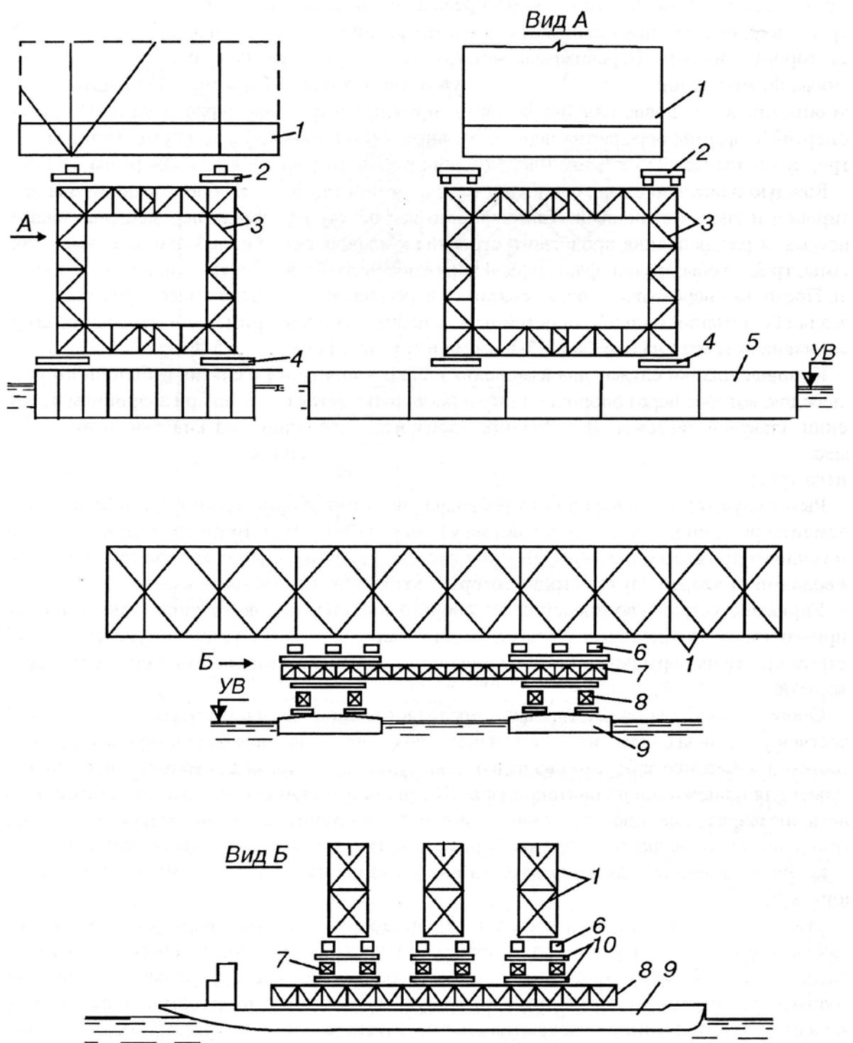
1 – пролетное строение; 2 – верхний ростверк; 3 – обстройка; 4 – нижний ростверк; 5 – плашкоут из pontonov; 6 – шпальные клетки; 7 – ферма; 8 – распределительная ферма; 9 – баржа; 10 – балочные ростверки
