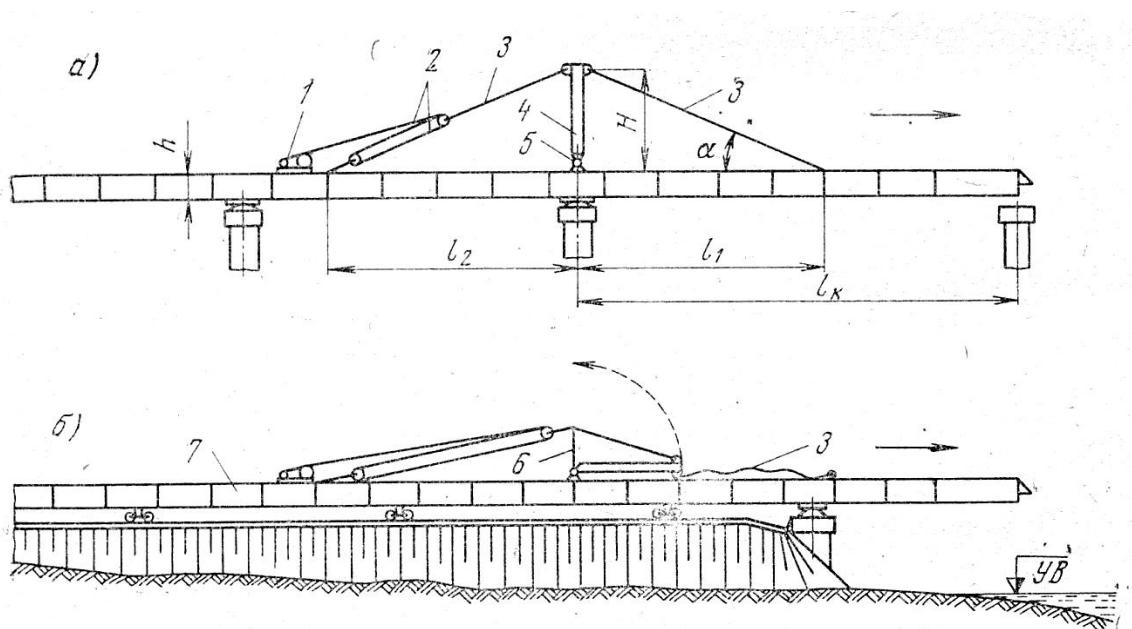
а – схема шпренгельного усиления консоли пролетного строения; б – схема монтажа шпренгеля; 1 – электрическая лебедка; 2 – полиспаст; 3 – растягиваемые элементы шпренгеля; 4 – стойка шпренгеля; 5 – шарнир; 6 – шеф-мачта; 7 – надвигаемые пролетные строения
