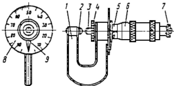
1 - скоба; 2 - пятка; 3 - микрометрический винт; 4 - стопор; 5 - стебель; 6 - барабан; 7 - трещотка (фрикцион); 8 - циферблат; 9 – стрелка
