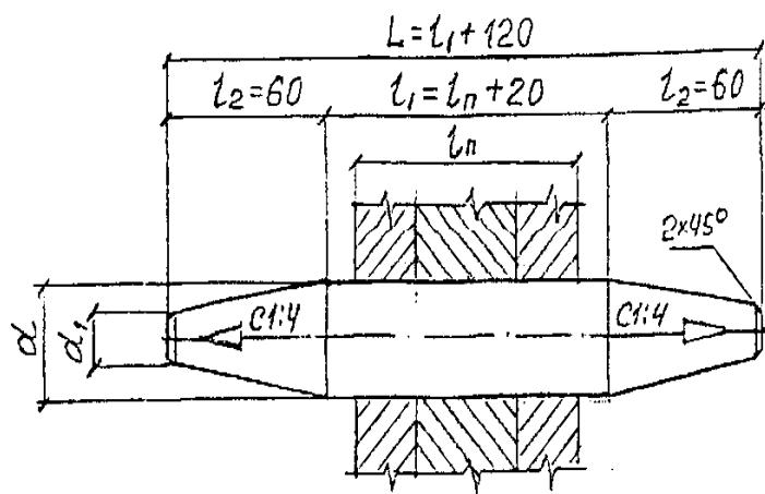
Рисунок 6.26 – Конструкция пробки
