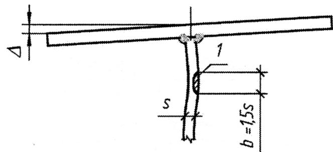
а – при прямой стенке; б – при искривленной стенке; 1 – полоса нагрева
