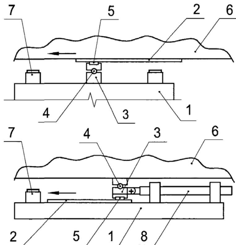
а – с переставным контртелом; б – с переставной кареткой; 1 – опорная поверхность пути скольжения; 2 – контртело; 3 – каретка; 4 – шарнир; 5 – полимерная прокладка; 6 – надвигаемая конструкция; 7 – домкрат для подъемки; 8 – домкрат для надвижки
