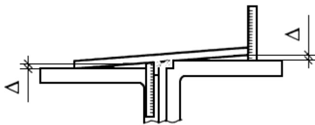
Рисунок И.18 – Измерение перекоса двумя угольниками и линейками
