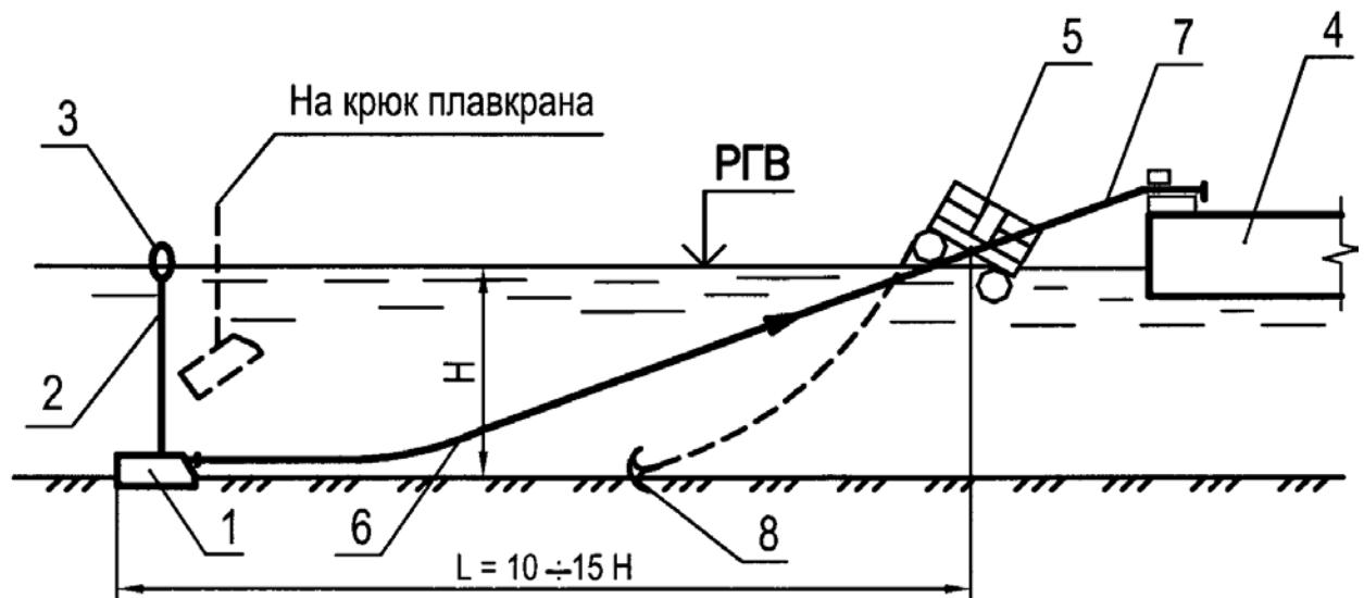
1 – железобетонный якорь-присос; 2 – строповочный канат; 3 – бакен; 4 – плавсредство; 5 – плавучий рым; 6 – якорный канат; 7 – папильонажный канат; 8 – весовой якорь; Н – глубина воды
