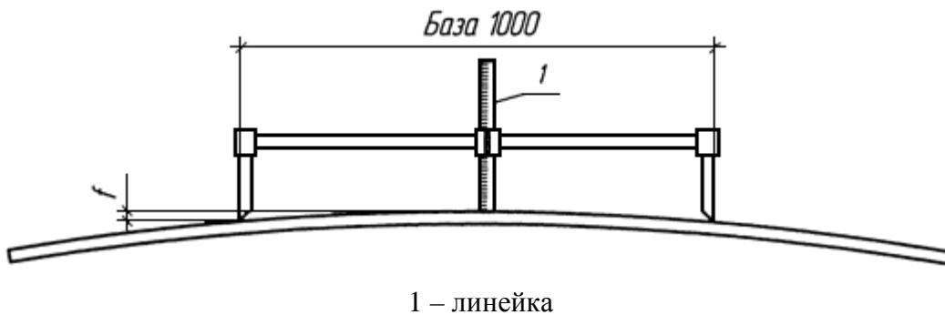
Рисунок И.16 – Измерение выпучивания и волнистости листа
