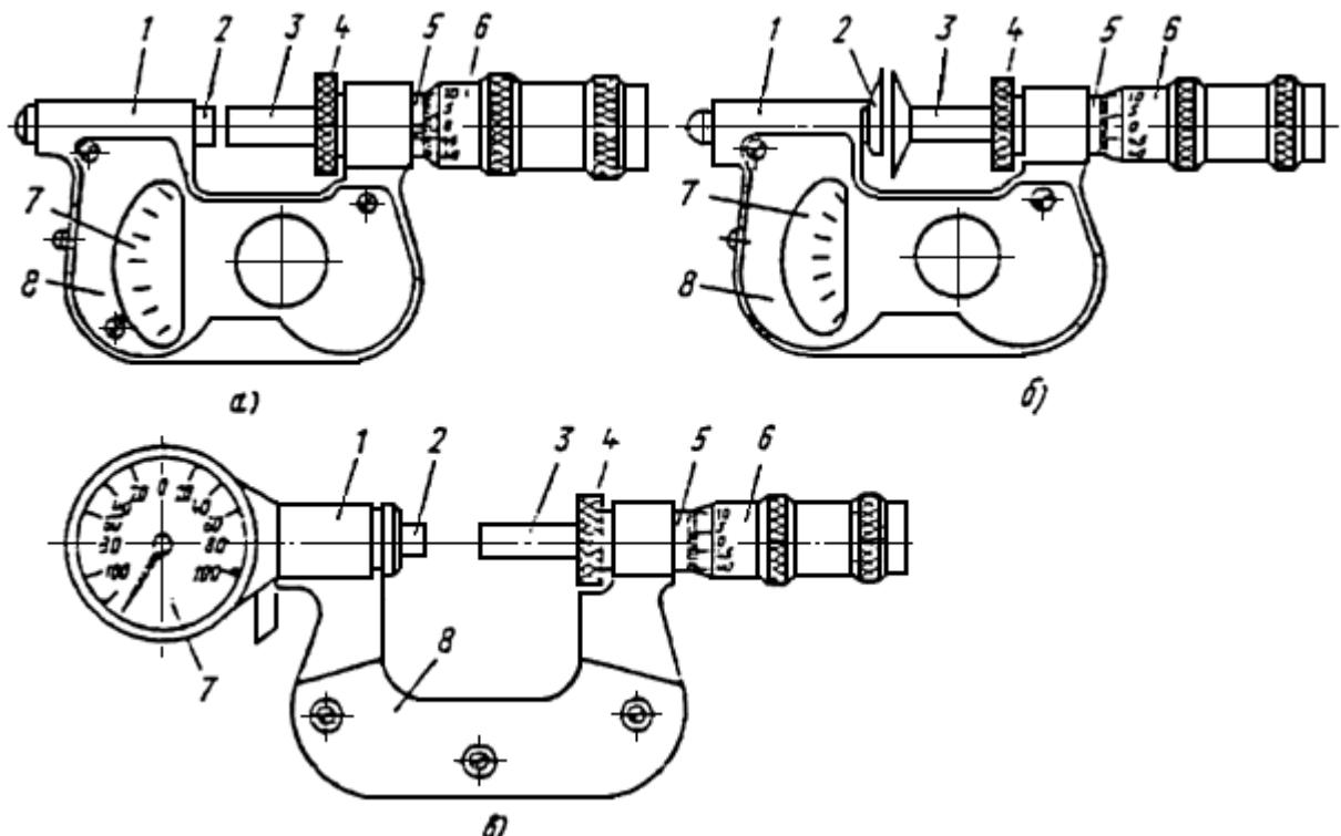
1 - скоба; 2 - подвижная пятка; 3 - микрометрический винт; 4 - стопор; 5 - стебель; 6 - барабан; 7 - отсчётное устройство; 8 - теплоизоляционная накладка
