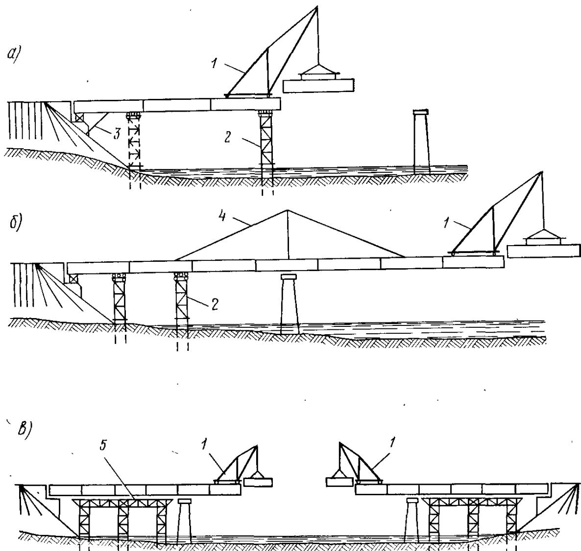
а – полунавесной монтаж; б – полунавесной и навесной монтаж со шпренгельным усилением; в – навесной монтаж; 1 – монтажный кран; 2 – временная опора; 3 – анкер; 4 – шпренгель; 5 – сплошные подмости
