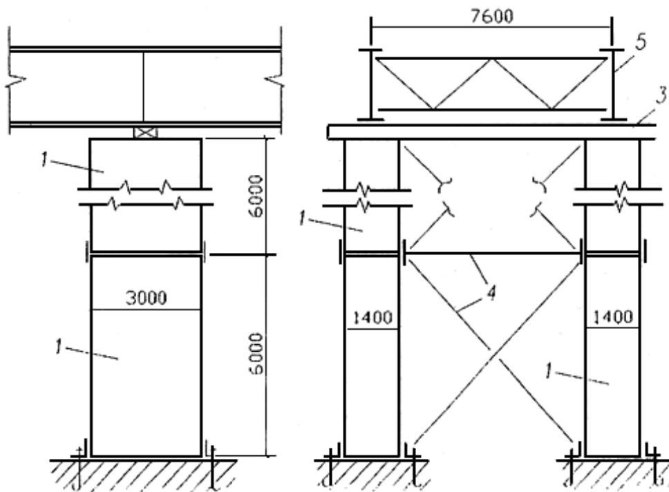
1 – ponton; 2 – пролетное строение временного моста; 3 – опорный пакет; 4 – связи; 5 – монтируемое пролетное строение
