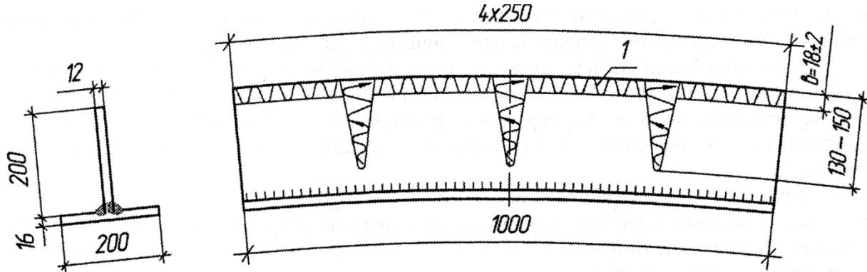
а – геометрическая форма и размеры «клина»; б – термическая правка тавра; 1 – полоса нагрева
