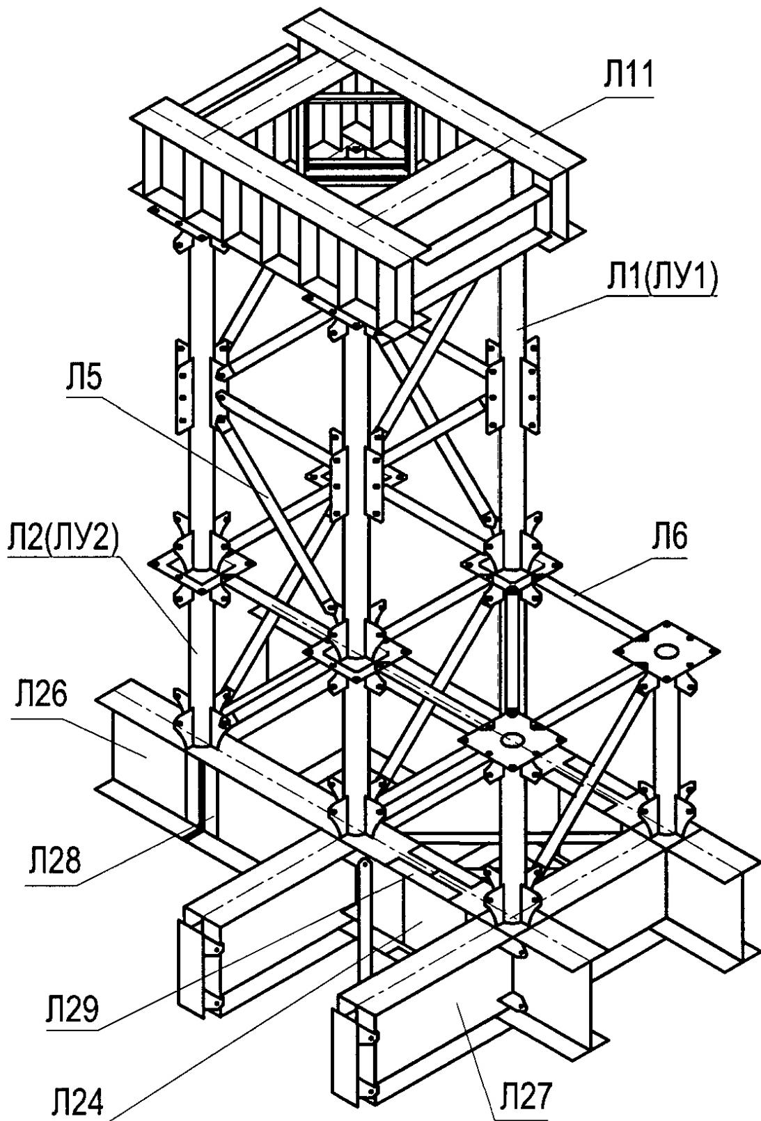
Рисунок 5.1 – Схема сборки временной опоры из инвентарных конструкций
