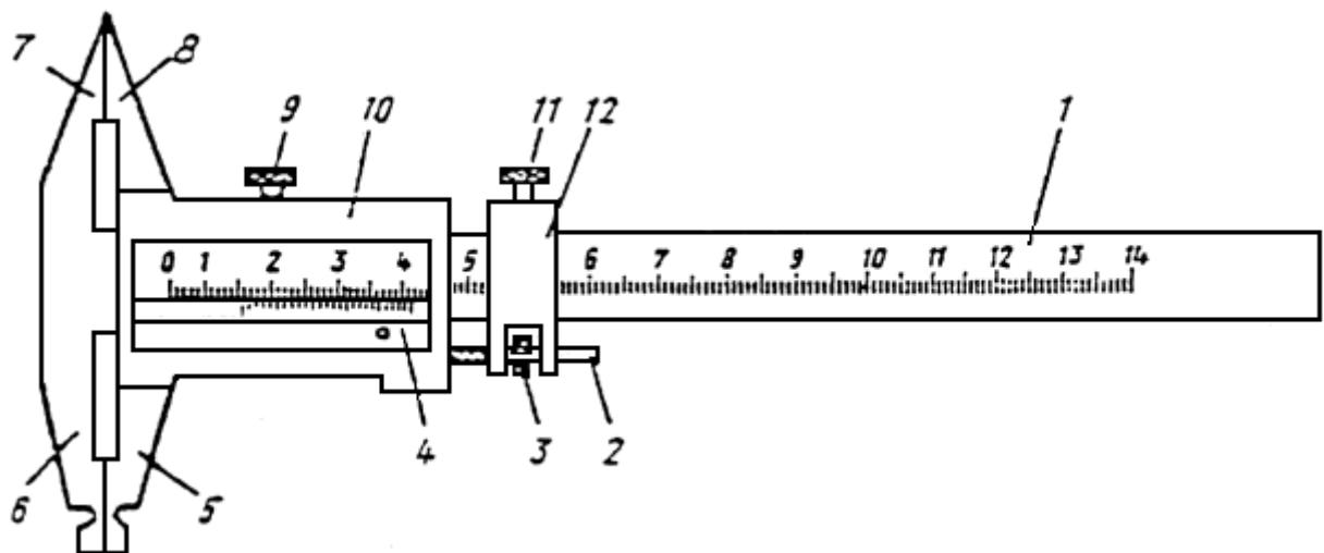
1 - штанга; 2 - микрометрический винт; 3 - гайка; 4 - нониус; 5 и 6 - губки нижние; 7 и 8 - губки верхние; 9 и 11 - стопорные винты; 10 - рамка; 12 – хомутик
