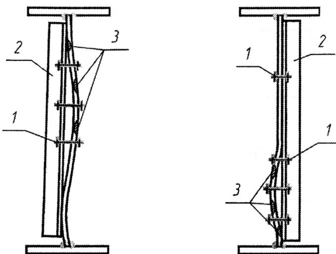
1 – струбцины или болты; 2 – уголок  $125 \times 125 \times 12$ ; 3 – полосы нагрева металла
