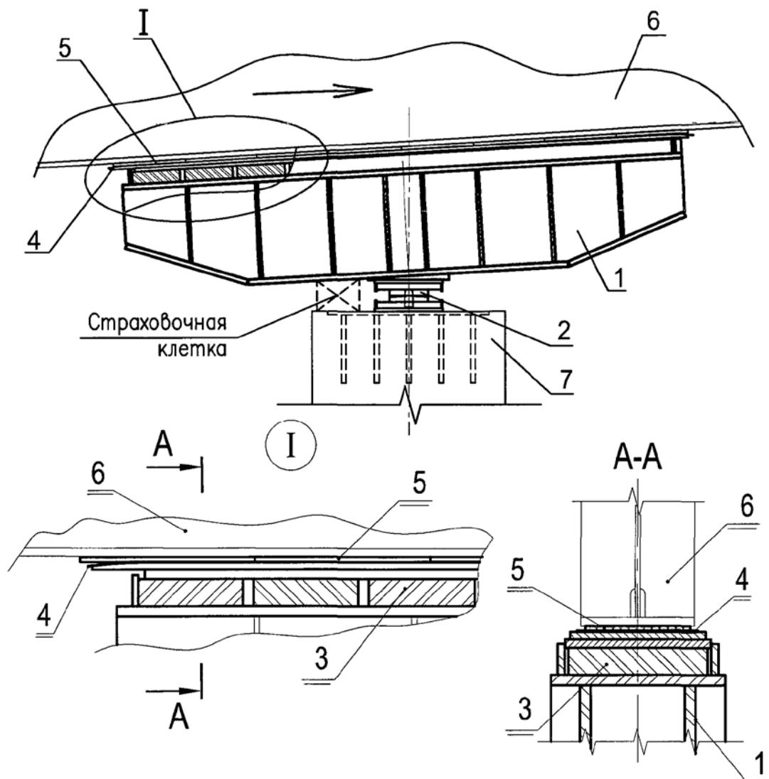
1 – накаточная (балансирная) балка; 2 – опорная часть (шарнир); 3 – резиновая прокладка;
