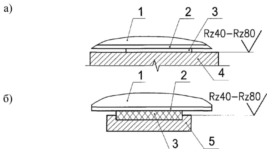
а – свободно опирающихся на шероховатую поверхность; б – заключенных в обойму; 1 – надвигаемая конструкция; 2 – контртело; 3 – полимерная прокладка; 4 – опорная поверхность; 5 – обойма
