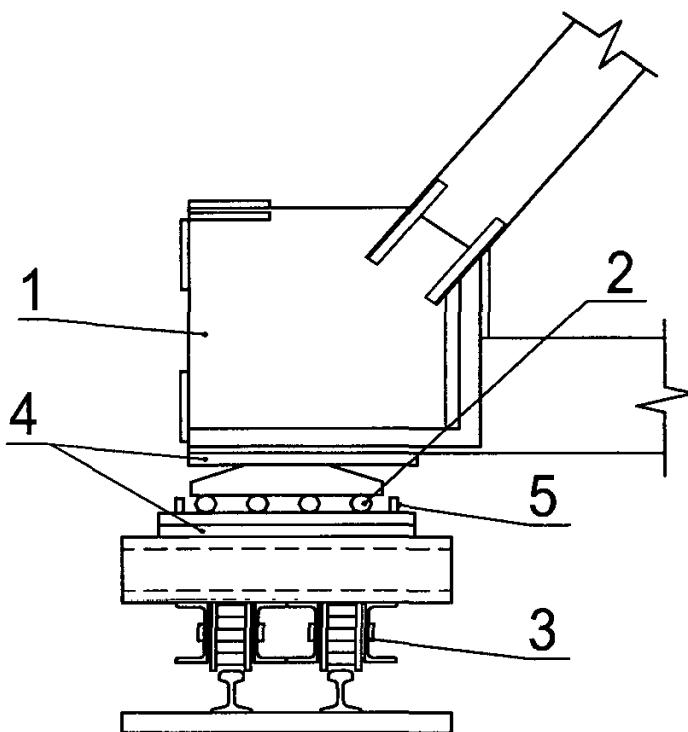
1 – опорный узел пролетного строения; 2 – катки; 3 – перекаточная тележка; 4 – опорные плиты тележки; 5 – ограничители положения катков
