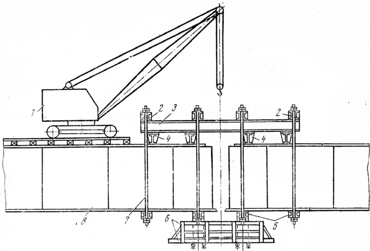
1 – монтажный кран; 2 – верхние поперечные пакеты; 3 – продольные пакеты; 4 – опорная балка; 5 – нижние поперечные пакеты; 6 – подмости; 7 – тяжи; 8 – пролетное строение
