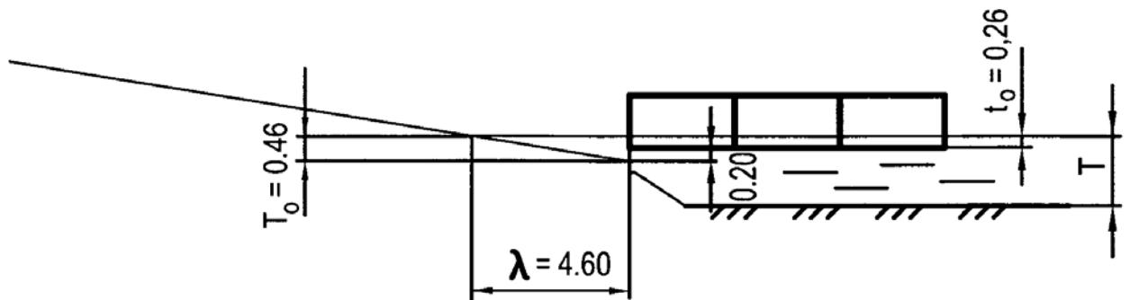
а – начало движения плашкоута; б – конец движения плашкоута;  $\lambda$  – длина подводной части спусковых дорожек;  $T_0$  – глубина воды над порогом при расчетном горизонте воды в период спуска плашкоута;  $t_0$  – осадка свободно плавающего плашкоута;  $T$  – глубина воды в месте спуска плашкоута на воду
