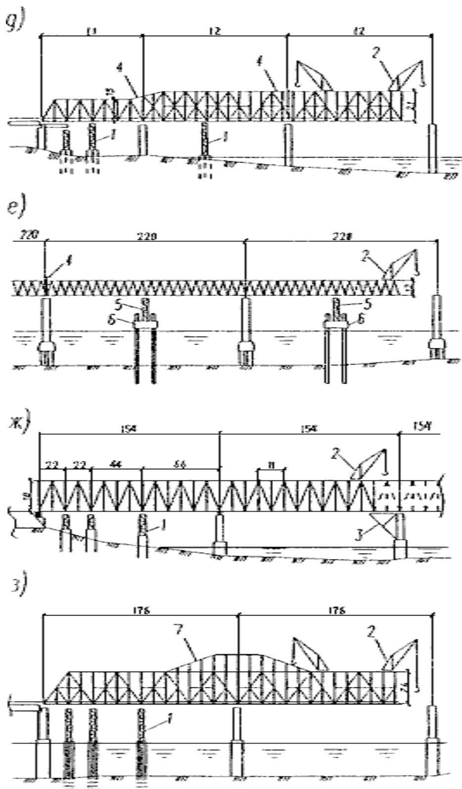
1 – временная опора; 2 – деррик-кран; 3 – приемная консоль; 4 – соединительные элементы; 5 – обстройка опор; 6 – фундамент временной опоры; 7 – шпренгель
