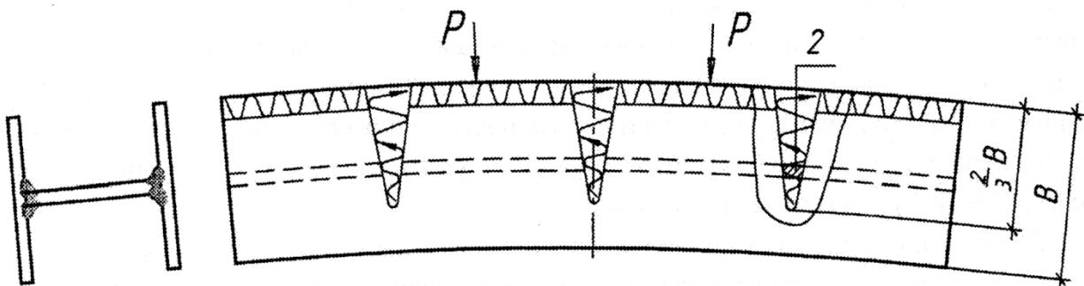
а – термомеханическая правка двутавра; б - термомеханическая правка Н-образного элемента; 1 – полоса нагрева; 2 – полоса нагрева стенки; Р - пригрузы
