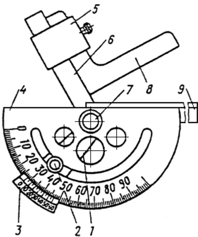
1 - сектор; 2 - стопор; 3 - нониус; 4 - основание; 5 - державка; 6 - линейка подвижная; 7 - ось; 8 - угольник; 9 - линейка съемная
