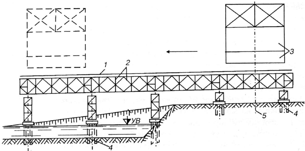
1 – накаточные пути; 2 – поперечный пирс; 3 – пролетное строение; 4 – свайный фундамент пирса; 5 – ось сборочных подмостей
