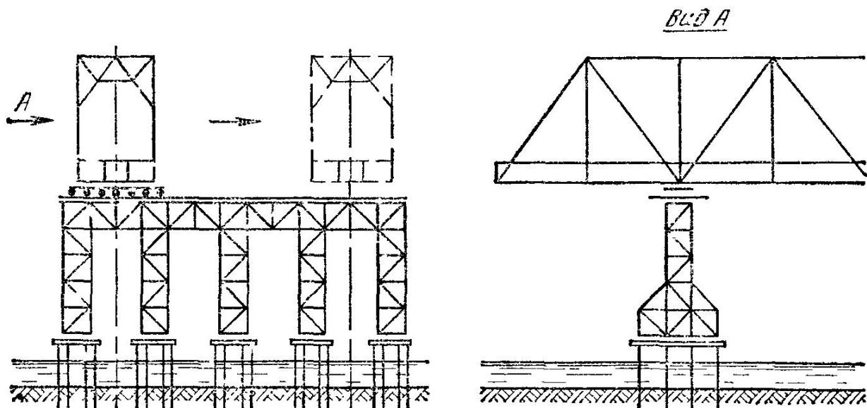
Рисунок 6.12 –Схема поперечной перекатки пролетного строения по пирсам
