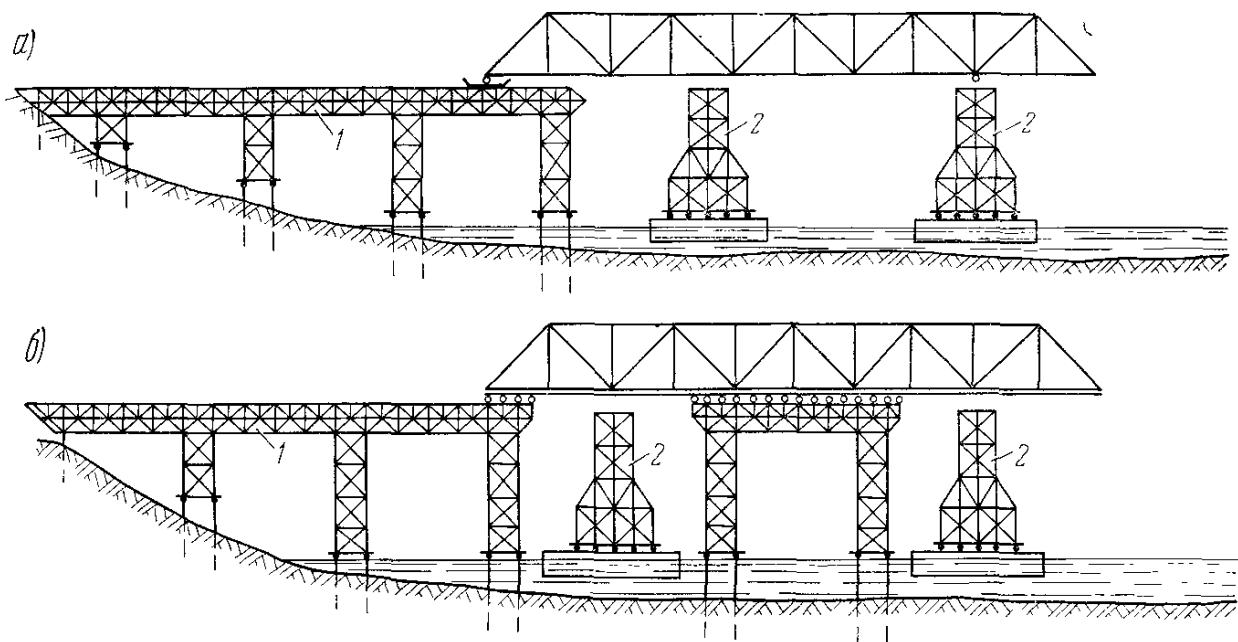
а – погрузка пролетного строения с продольного пирса; б – то же с пирса, имеющего проемы; 1 – продольный пирс; 2 – плавучие опоры
