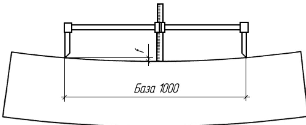
Рисунок И.19 – Измерение саблевидности на базе 1 м
