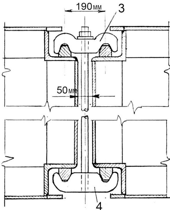
а – болтовой стык; б – вариант сцепа для сборки на плаву; в – замковый стык; 1 – стыковая планка; 2 – конический самозахватный штырь; 3 – верхний замок; 4 – штанга
