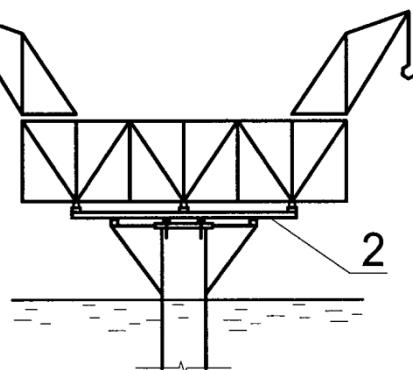
а – с опиранием на временную опору; б – с закреплением за постоянную опору; 1 – деррик-краны; 2 – опорное устройство; 3 – временная опора; 4 – постоянная опора
