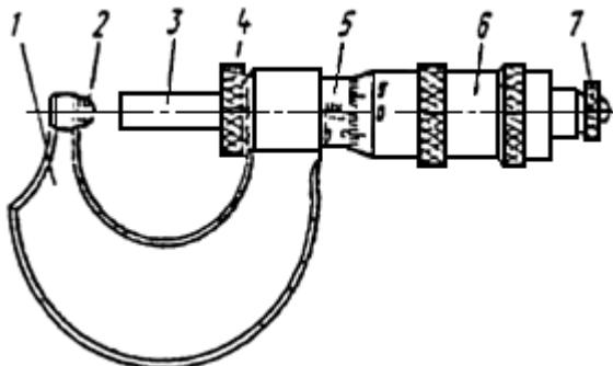
1 - скоба; 2 - пятка; 3 - микрометрический винт; 4 - стопор; 5 - стебель; 6 - барабан; 7 - трещотка (фрикцион)
