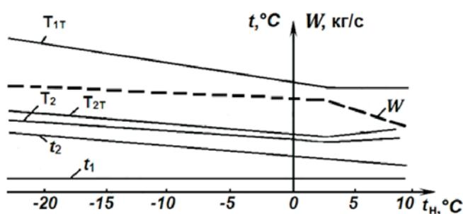
$W$  – расход теплоносителя, кг/с;  $T_{1T}$ ,  $T_{2T}$  – температура по графику соответственно подающего и обратного теплоносителя, °С;  $T_2$  – фактическая температура воздуха после воздухонагревателя, °С;  $t_1$ ,  $t_2$  – температура воздуха соответственно до и после воздухонагревателя, °С;  $t_n$  – температура наружного воздуха, °С
