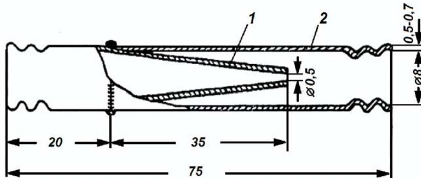
1 – трубка с заостренным концом; 2 – металлическая цилиндрическая трубка
