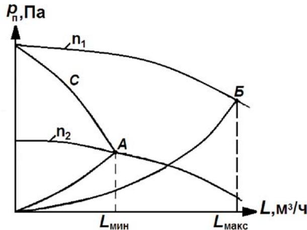
Рисунок 13.1 – Режим работы вентилятора в системе количественного регулирования направляющим аппаратом (кривая С) или частотой вращения вентилятора ( $n_1 > n_2$ )
