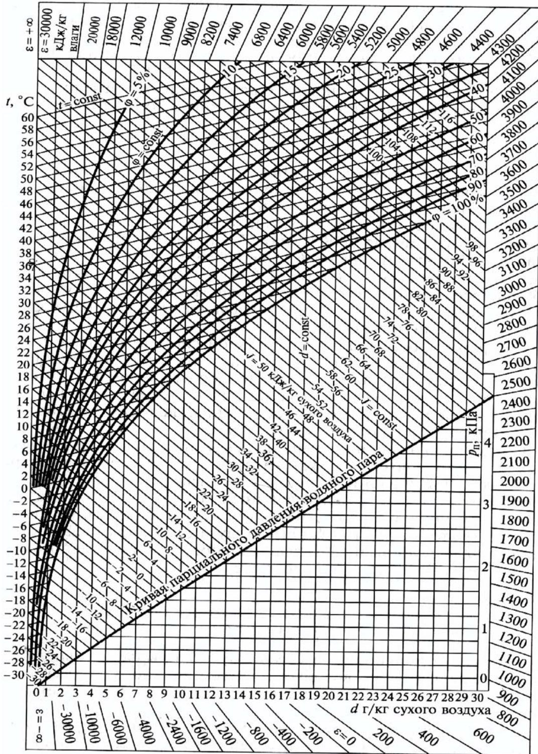
Графическая зависимость между параметрами (температура  $t$ , °C; относительная влажность  $\phi$ , %; энтальпия  $J$ , кДж/кг; влагосодержание  $d$ , г/кг; парциальное давление водяного пара  $p_v$ , кПа), характеризующими состояние влажного воздуха при постоянном давлении.
