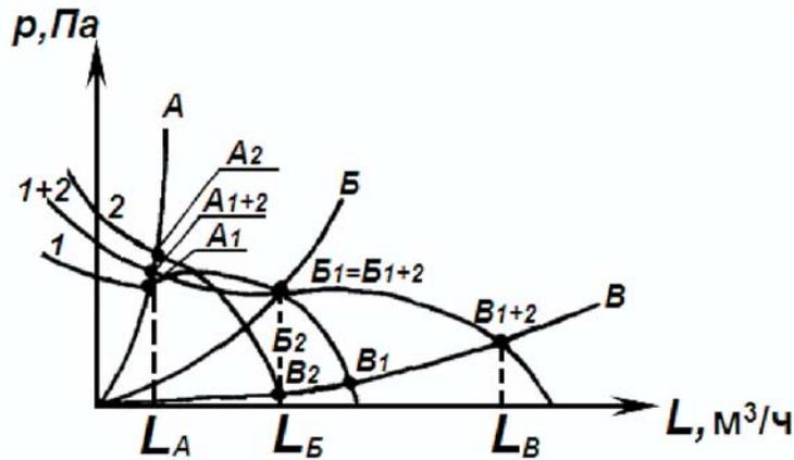
Рисунок 9.5 – Параллельная работа двух вентиляторов в сети
