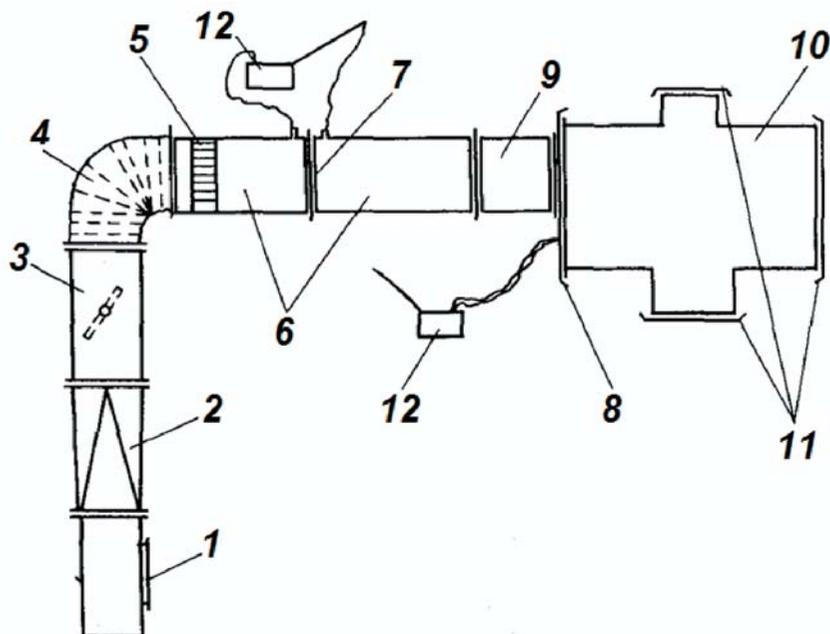
1 – переносной вентилятор; 2 – соединительный воздуховод; 3 – дросселирующее устройство; 4 – присоединительный воздуховод; 5 – выравнивающая решетка; 6, 9 – воздуховод для измерения расхода воздуха; 7 – место измерения расхода воздуха; 8 – фланец; 10 – испытываемый воздуховод; 11 – заглушка; 12 – микроманометр (манометр) для измерения величины статического давления в воздуховоде или присоединительном воздуховоде
