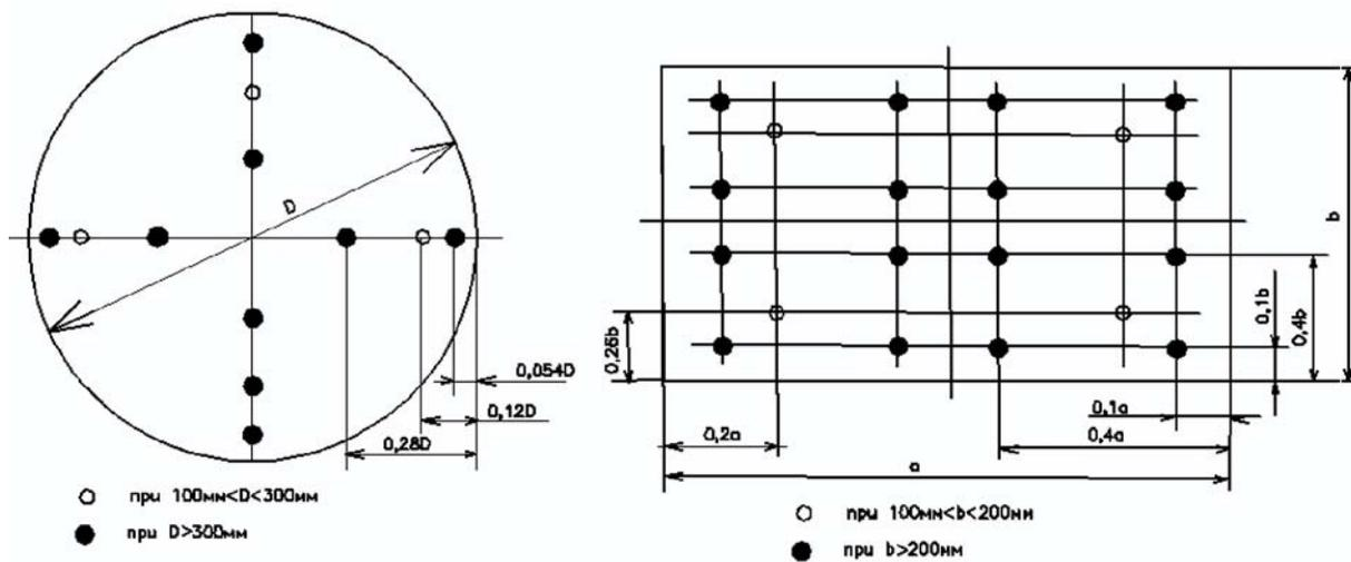
$D$  – диаметр воздуховода;  $a, b$  – размеры воздуховода
