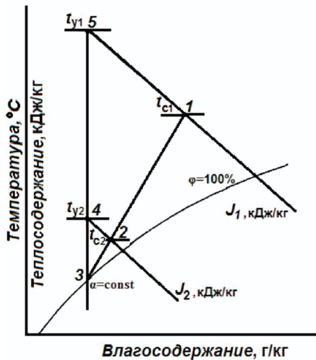
Рисунок 9.8 – Процессы обработки воздуха в воздухоохладителях
