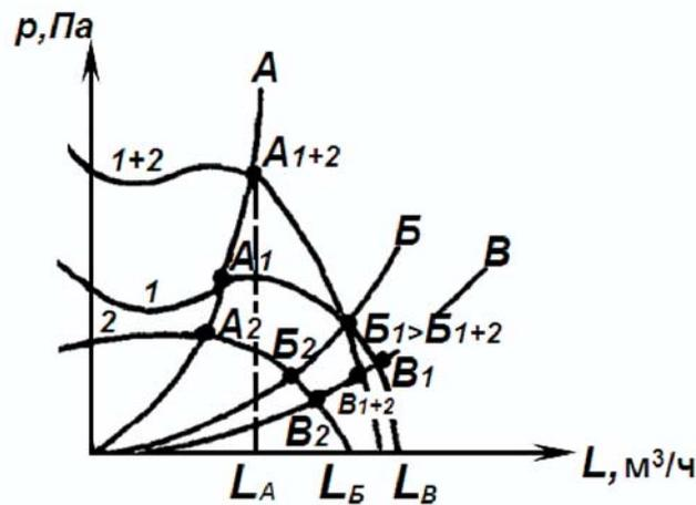
Рисунок 9.6 – Последовательная работа двух вентиляторов в сети
