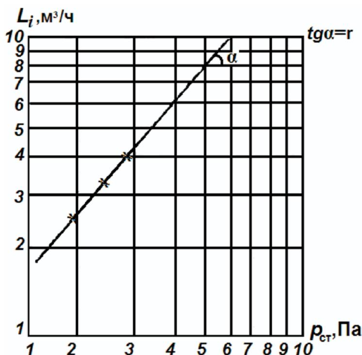
Рисунок 9.2 – График зависимости  $L_i = R (p_{ct})^r$ , полученный по результатам испытаний сетей воздуховодов на герметичность, где  $R$  – коэффициент градуировки, равный расходу воздуха при  $p_{ct} = 1$  Па
