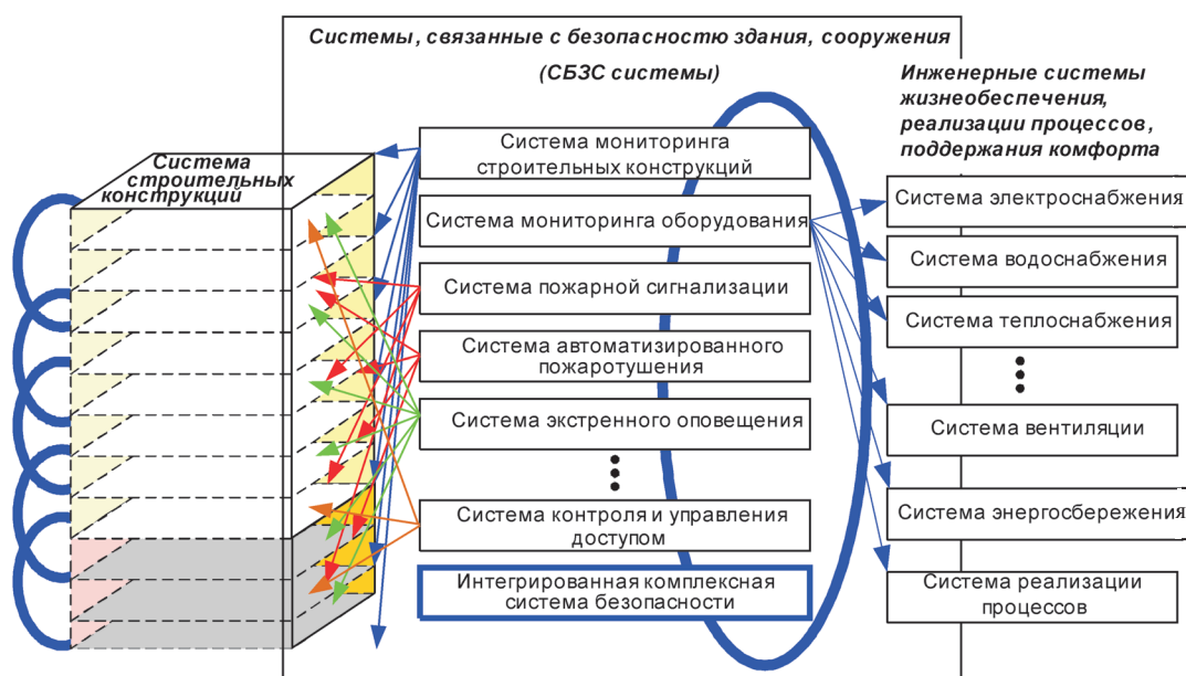
Рисунок 1 – Высотное здание (сооружение) как сложная техническая система (упрощенная модель)
